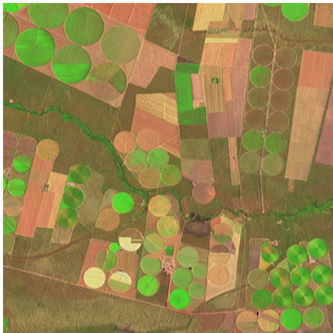
Figura 1. Composição colorida do satélite Landsat 8 (RGB 654 e banda 8 como sombra de relevo) para visualização dos equipamentos de pivô central.
