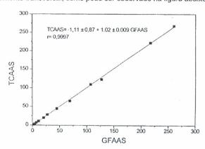
A utilização do filamento de tungstênio como atomizador eletrotérmico para a determinação de itérbio em matrizes biológicas é uma alternativa viável, aos estudos de nutrição animal, permitindo uma redução de dez vezes a concentração do marcador adicionada em relação aos experimentos realizados com FAAS.
