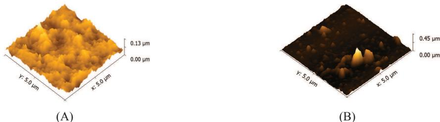
Figura 3. Micrografias de força atômica para os filmes de Qui/Pedot:PSS (A) e Qui/Ft (B) com 7 bicamadas.
