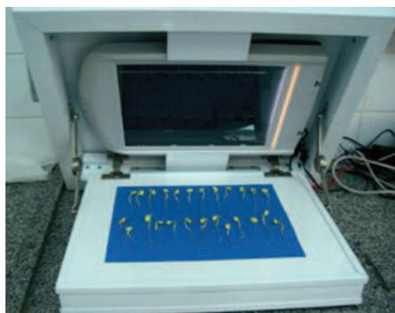
Figura 2. *Scanner* adaptado para digitalização das imagens das plântulas.
