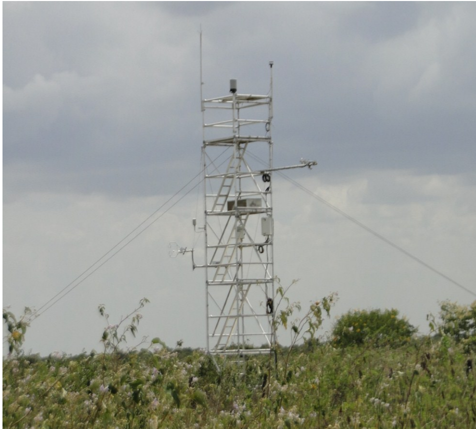
Fig.1. Torre micrometeorológica no centro de uma área de caatinga degradada, na Chapada do Araripe, Pernambuco.
