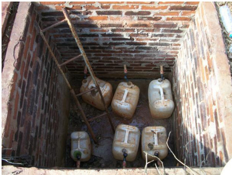
Figura 2 - Poço de observação onde mensalmente é coletada a água dos lisímetros
