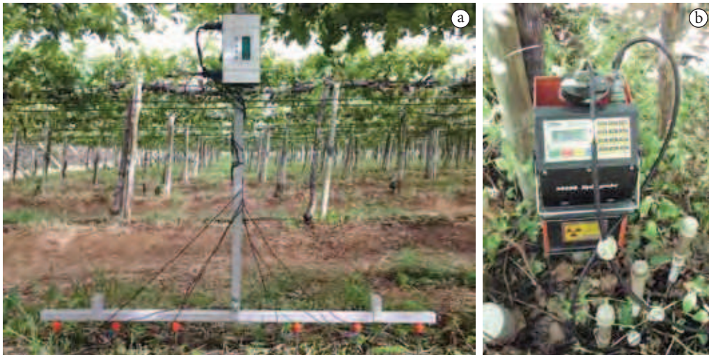
Figura 1. Medidor portátil da condutividade elétrica aparente do solo (A) e a sonda de nêutrons utilizada para o monitoramento da umidade do solo (B).
