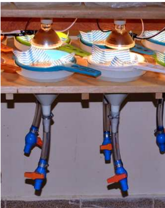
Figura 1. Extrator de enquitreídeos com aquecimento por lâmpadas incandescentes baseado em O'Connor (1962).
