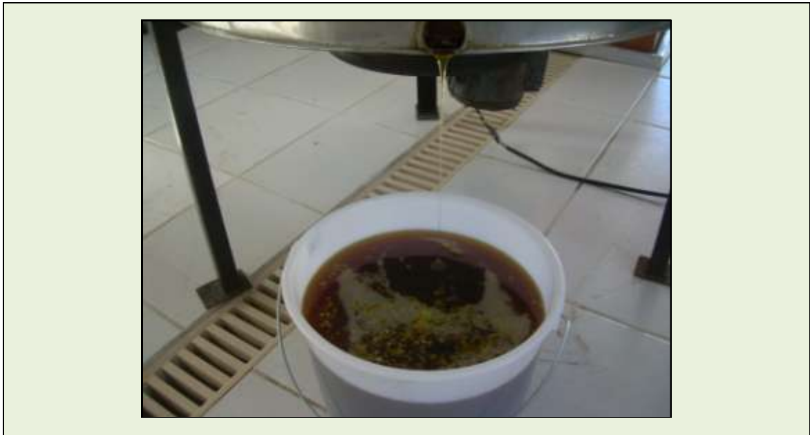
Figura 43: Mel escorrendo da centrífuga para dentro de balde.
