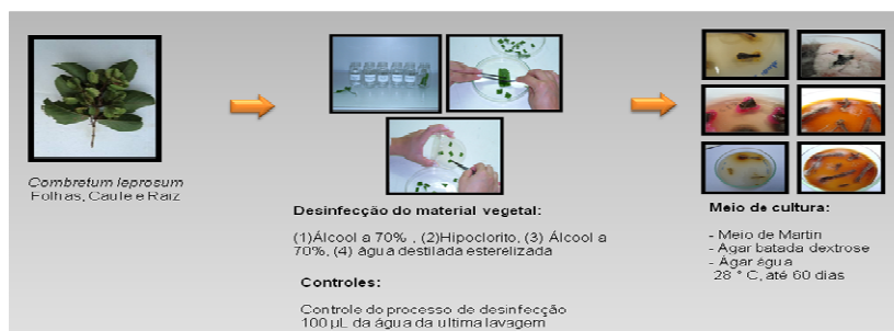
Figura 1 - Esquema com as etapas do isolamento dos micro-organismos endofíticos
