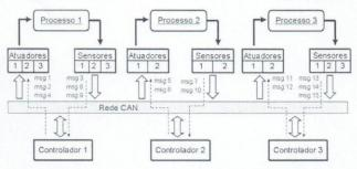
Figura 3. Sistema de Controle via Rede CAN com três Malhas de Controle
