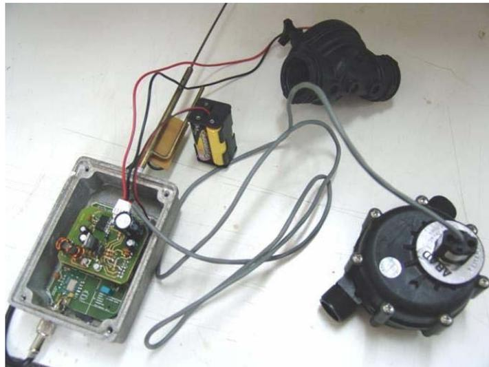
Figura 7: nó atuador e válvula solenóide.
