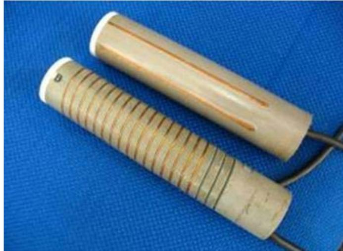
Figura 4: Foto sensor capacitivo.
