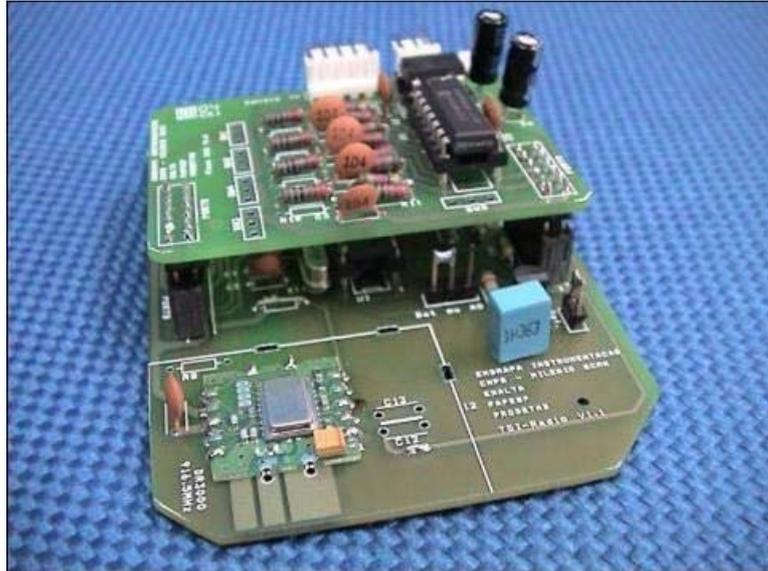
Figura 6: circuito eletrônico do nó sensor, abaixo a esquerda detalhe do transceptor.
