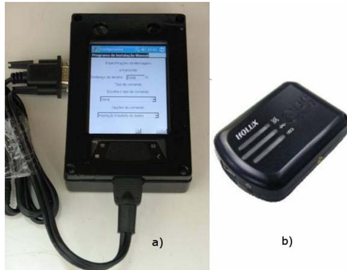
Figura 9: kit de instalação, a) palm e b) gps.
