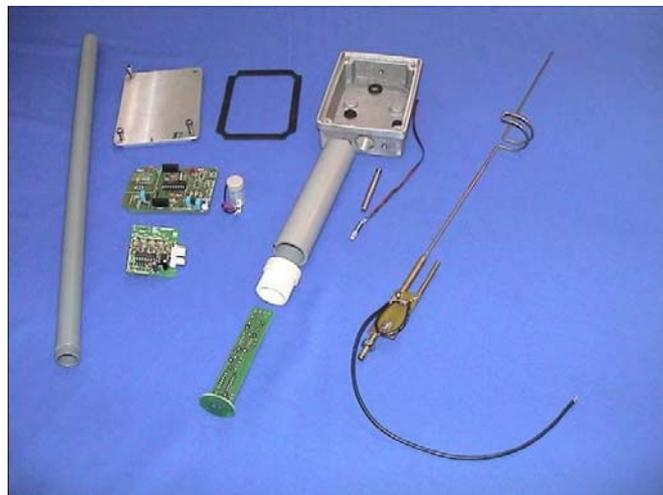
Figura 5: caixa de alumínio, antena, bateria e circuitos do nó sensor.
