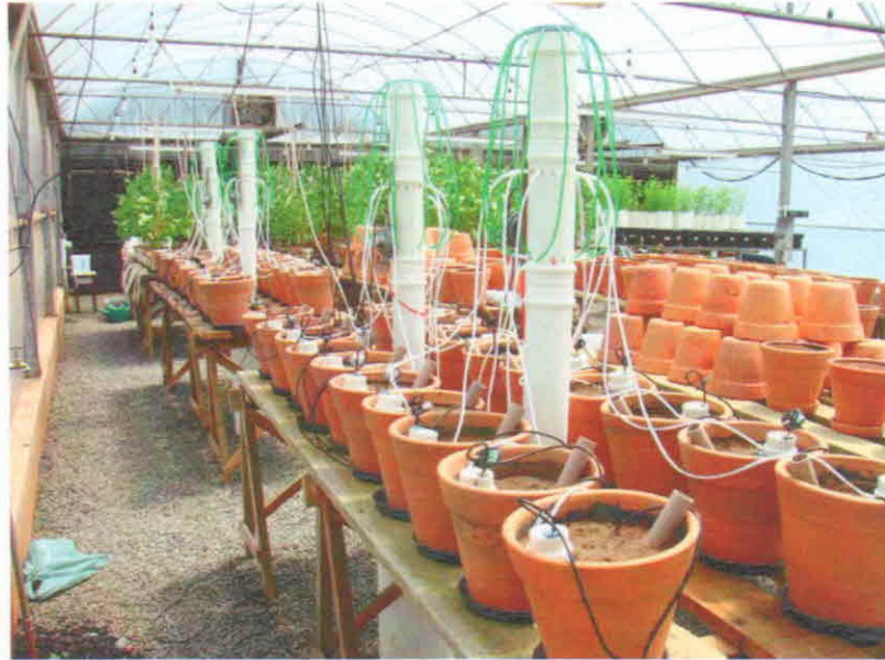
Figura 3. Sistema de gotejamento a gás montado em casa de vegetação na Embrapa Pecuária Sudeste, São Carlos –SP, para experimento com plantas medicinais.
