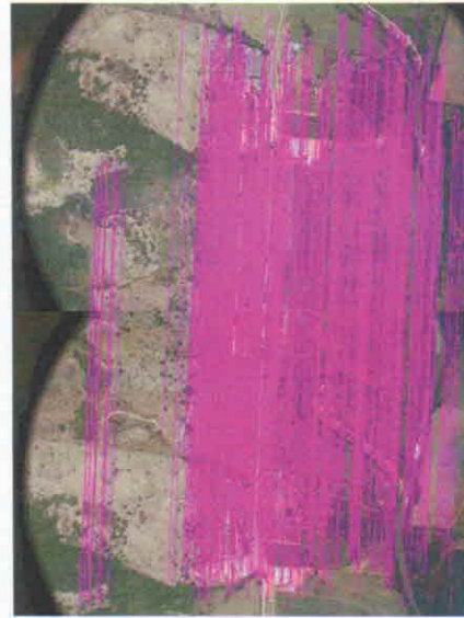
Figura 3. Exemplo de aquisição dos inliers entre duas imagens sequenciais.
