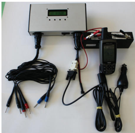
Figura 4. Ilustração do sistema protótipo de medida de condutividade elétrica do solo.
