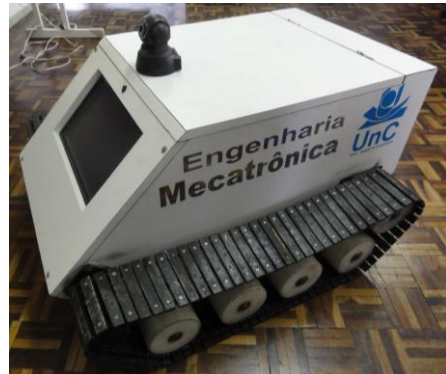
Fig. 1. Tanque-Robô com câmera acoplada e monitor.
