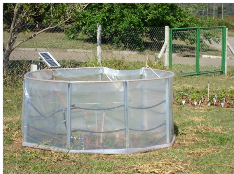
FIGURA 2. Estufa de topo aberto modificada. Embrapa Meio Ambiente, Jaguariúna-SP.
