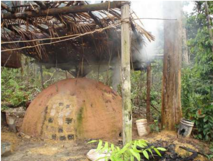
Fig. 5. Técnica de carbonização utilizando forno de tijolo de barro, conhecido localmente no Amazonas como “rabo quente”.
