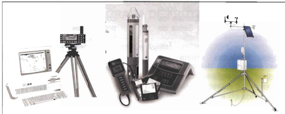
Figura 3. Equipamentos DGPS (Diferential Global Position for Satellite), sondas multiparâmetros e Estação de Aviso, utilizados no monitoramento da Qualidade Ambiental.
