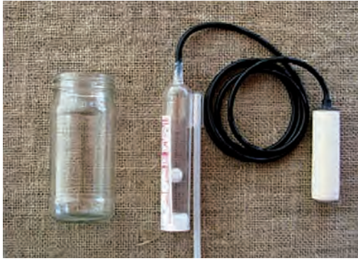
Figura 4. Sistema Irrigas® comercial, na sua forma básica, incluindo cápsula porosa (sensor), tubo de plástico flexível, cuba de leitura e frasco para teste de imersão.
