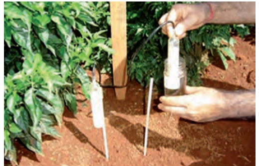
Figura 5. Leitura de sensores Irrigas® instalados em lavoura de pimenta por meio da introdução da cuba de leitura em um frasco com água.
