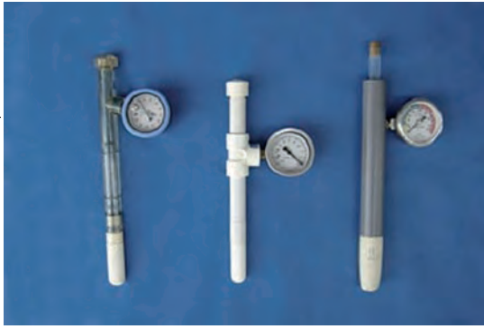
Figura 2. Tensiômetros com vacuômetro metálico tipo Bourdon.
