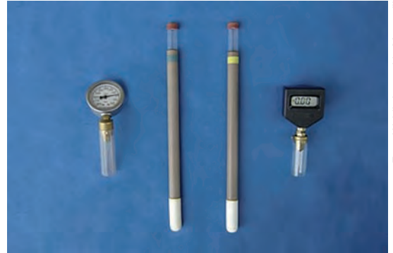
Figura 3. Tensiômetros de punção para leitura com tensímetro analógico ou digital.
