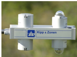
Saldo radiômetro CNR1
