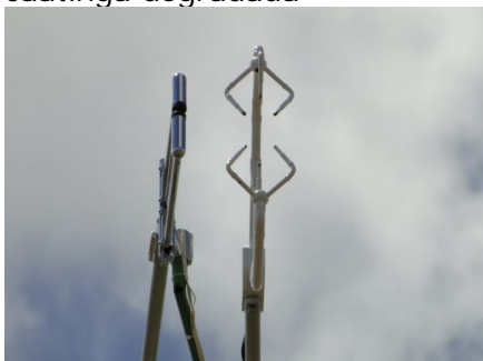
Sônico e higrômetro Krypton Figura 9.
