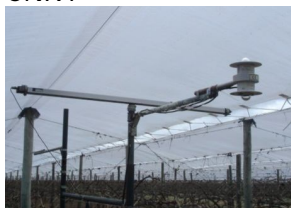
Albedômetro e PAR Linear
