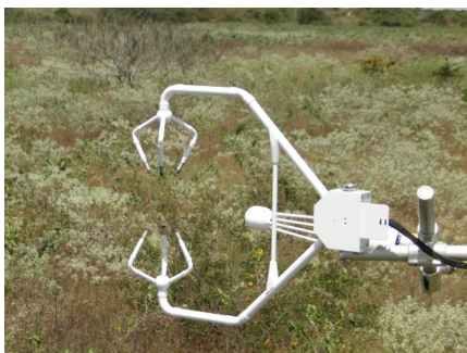
Sônico e Li-cor 7500 em área de caatinga degradada
