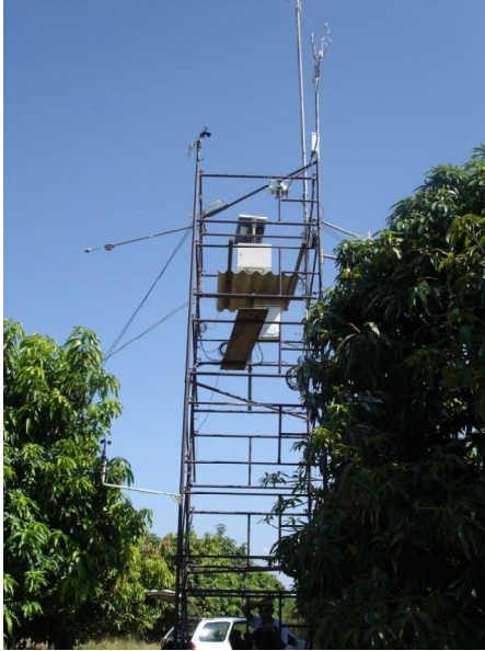
Torre micrometeorológica com razão de Bowen e correlações turbulentas em pomar de mangueira
