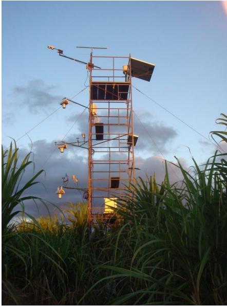
Torre micrometeorológica com razão de Bowen e correlações turbulentas em canal
