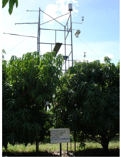
Torre micrometeorológica com razão de Bowen em pomar de mangueira
