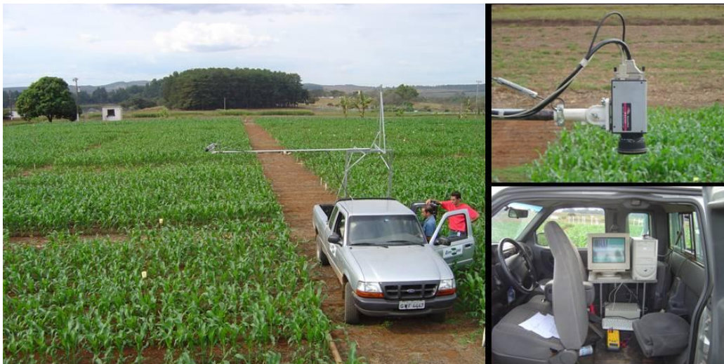
Figura 1. Vista geral de um bloco do experimento e do sistema de aquisição de imagem de superfície constituído de uma câmera digital, um microcomputador, um DGPS e um braço de sustentação da câmera acoplado a uma estrutura presa a uma camionete ranger.
