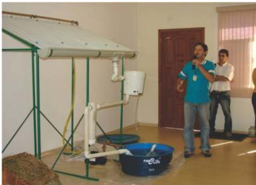
Figura 1. Cisterna didática usada nas atividades do TSGA
