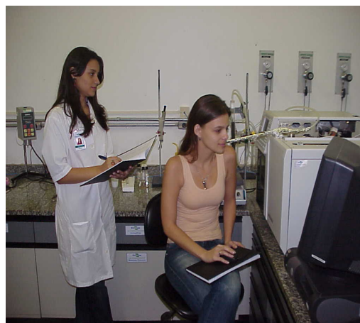
Figura 11 - Análise olfatométrica através da técnica Osme . Detalhes do julgador utilizando o mouse do computador para registrar a intensidade do odor percebido (A) e detalhe da analista anotando a descrição do odor (B).
