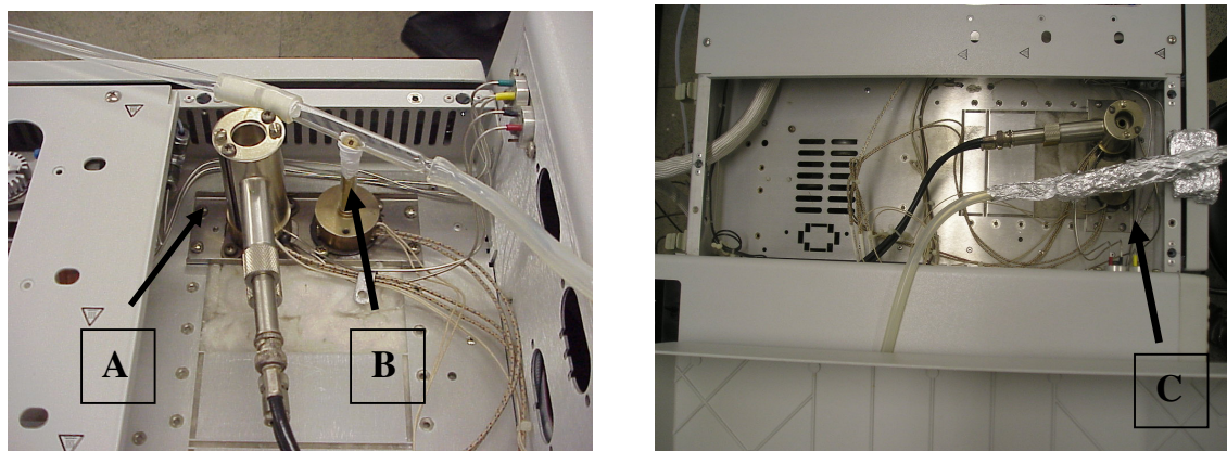
Figura 9 - Vista superior da torre do FID (A), encaixe do tubo de vidro sobre a saída da coluna (B) e revestimento de fibra de vidro e papel alumínio para manter o aquecimento e evitar a condensação dos voláteis no tubo de vidro (C).
