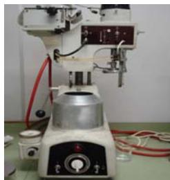
Figura 1. Viscoamilógrafo usado na preparação das soluções filmogênicas
