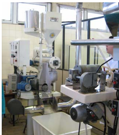
Figura 1. Extrusora industrial Inbramaq RX 50 (Embrapa Agroindústria Alimentos, Rio de Janeiro).
