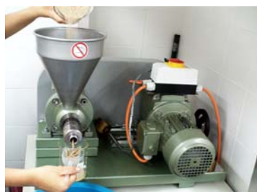
Figura 2. Prensa usada na extração do óleo de gergelim.
