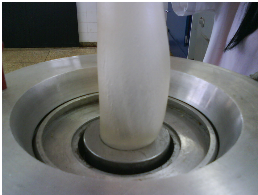
Figura 1 – Imagem fotográfica do biofilme extrudado de amido e glicerol em extrusora de sopro
