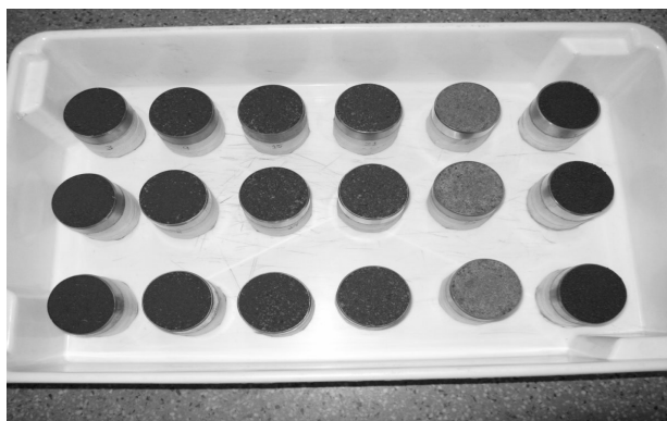
Fig. 1 - Montagem experimental utilizada com os anéis volumétricos preenchidos com os solos e misturas com o chamote.
