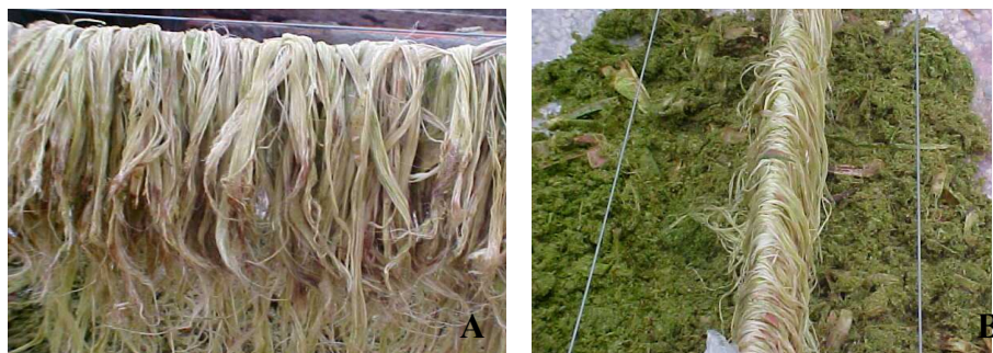
Figura 2 - Produtos e resíduos provenientes do processamento de folhas curauá, A) fibra e B) mucilagem
