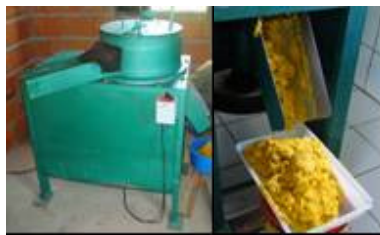
Figura 2. Despulpadora e polpa da bociáúva obtida da extração mecânica.
