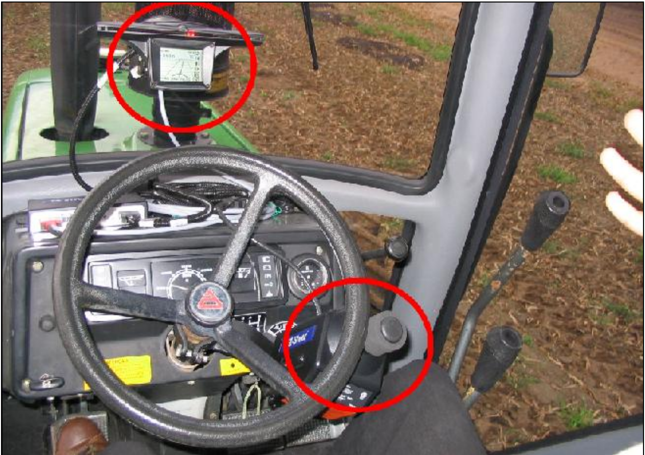
Figura 2. Trator equipado com barra de luz e piloto automático. (Foto: Álvaro Resende).
