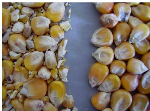
**Figura 1-** amostras de grãos coletadas da mesa gravitacional: saída 1 (esquerda) e saída 5 (direita)
