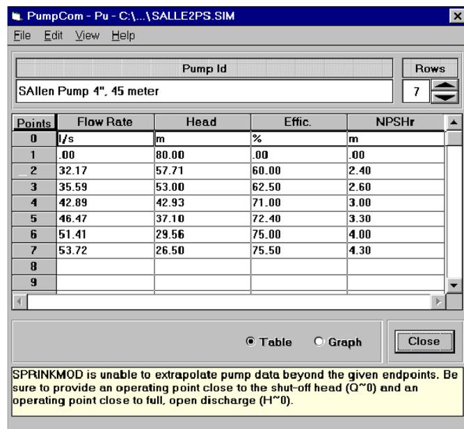
Figura 1. Caixa de diálogo para entrada e edição de dados de curva de bomba
