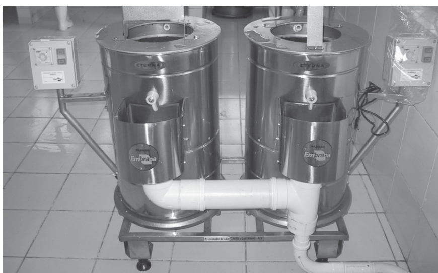
Figura 5. ‘Processador de Cenourete® e Catetinho®’, composto das unidades de torneamento - esquerda - e acabamento - direita. (‘Processador de Cenourete® e Catetinho®’, consisting of the shaping unit - left - and the polishing unit - right). Brasília, Embrapa Hortaliças, 2008.
