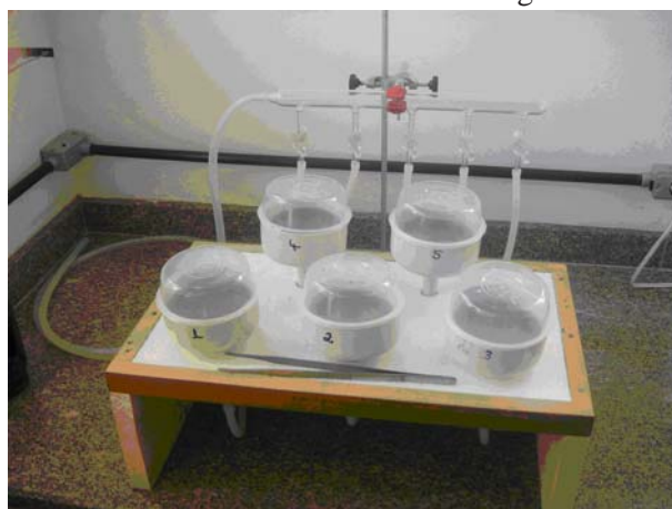
Figura 5. Aparato para a desidratação ultra-rápida desenvolvida no Laboratório de Análise de Sementes do BASEMFLORE – Embrapa Florestas.
