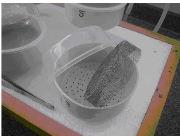
Figura 6. Detalhes do aparato para a desidratação ultra-rápida desenvolvida no Laboratório de Análise de Sementes do BASEMFLOR – Embrapa Florestas.
