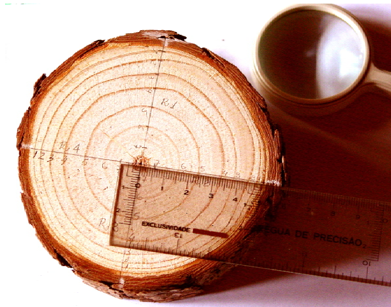
Figura 1: Medição manual de raios sobre a fatia seca e lixada Figure 1: Manual measurement of radii on the dry and sanded disc
