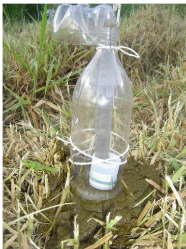
Figura 1: Vista da câmara para análise de volatilização posicionada sobre o tratamento com fezes.
