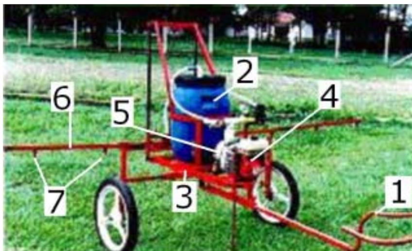
Figura 1. Principais componentes do pulverizador à tração humana: alça de tração (1), tanque de produtos (2), chassi (3), motor (4), bomba centrífuga (5), barra de pulverização (6) e bicos pulverizadores (7).
