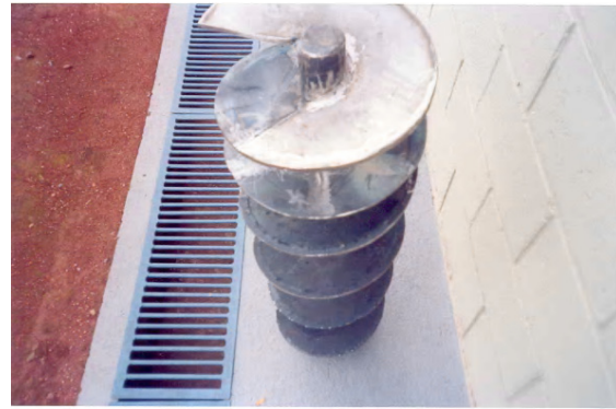
Figura 7b. Rosca sem fim antes da modificação.
