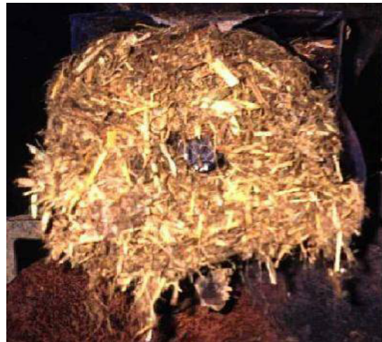
Figura 8. Aspecto da rosca sem fim quando da ocorrência de compactação, levando ao travamento.
