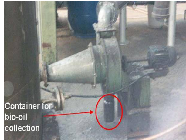
Figura 12. Ventilador centrífugo usado para a separação de amostras de bio-óleo.
