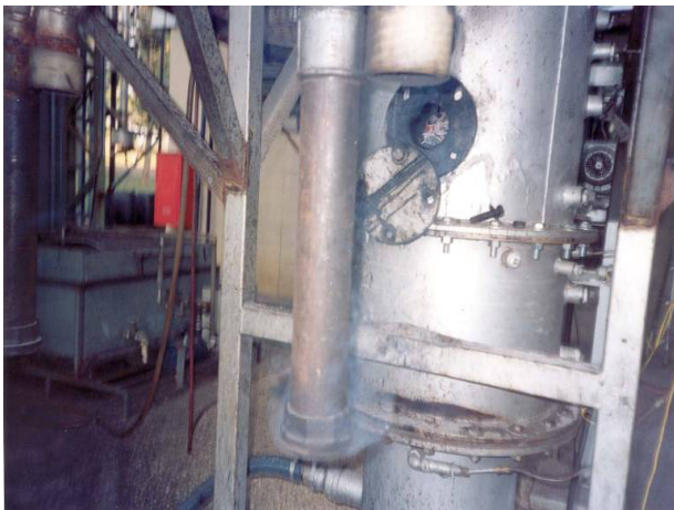
Figura 11. Acúmulo de biomassa e carvão no leito: estagnação do processo.
