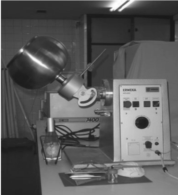
Figura 1. Equipamento pequeno de encapsulação de sementes com regulador de velocidade e compressor de ar, pertencente à Universidade Politécnica de Madrid, Espanha.
