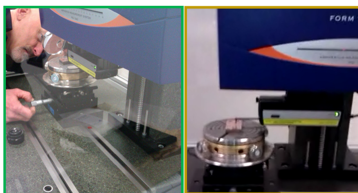
Figura 6.1. Posicionamiento y medición de la rugosidad superficial en una pieza mecanizada.
