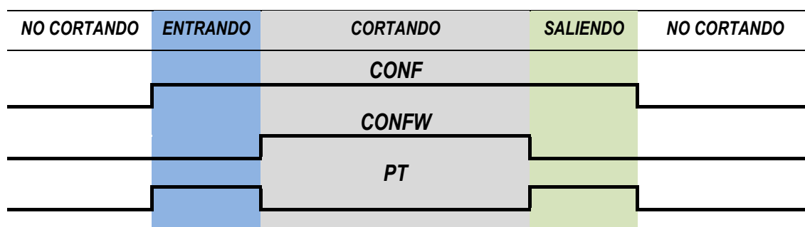
Figura 5.7. Diagrama del comportamiento esperado de las señales digitales durante los estados del proceso de corte.
