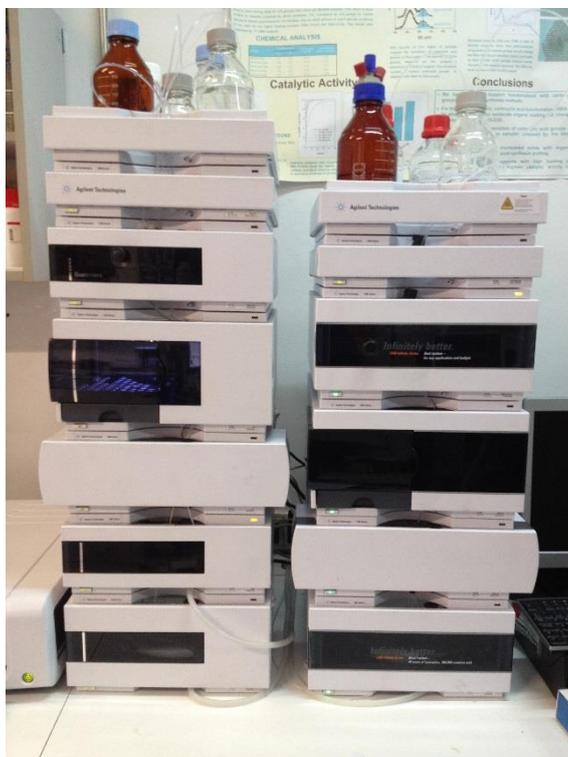
**Figura 3.9:** Equipos HPLC utilizados para las medidas de los diferentes azúcares, ácidos y productos secundarios de reacción (Agilent Technologies).
