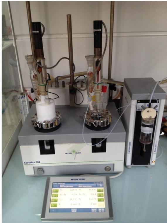
**Figura 3.6:** Reactor Mettler-Toledo Easy Max® discontinuo a presión atmosférica.
