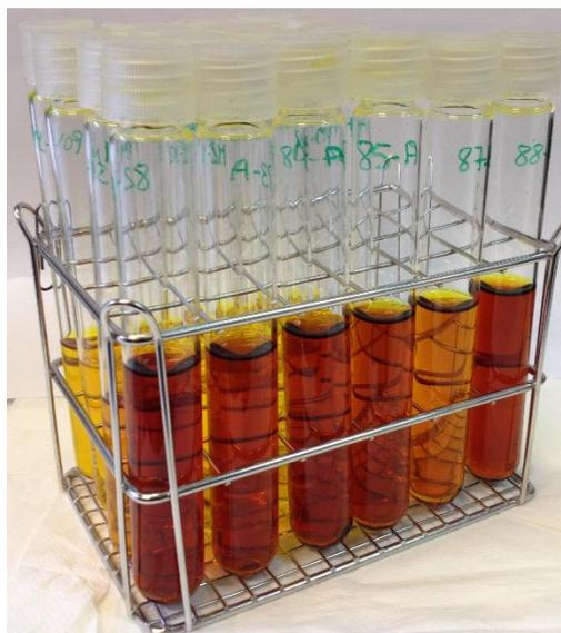
**Figura 3.12:** Preparación de las muestras para el análisis de los TRS por el método de Miller [5].
