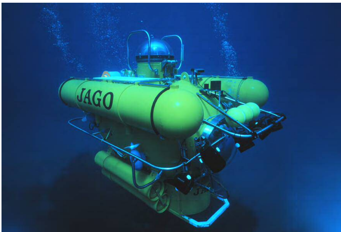
Figura 5 – Sumergible tripulado JAGO (Leibniz Institute of Marine Sciences, Kiel) usado para la grabación de los vídeo-transectos [IFM-GEOMAR].
