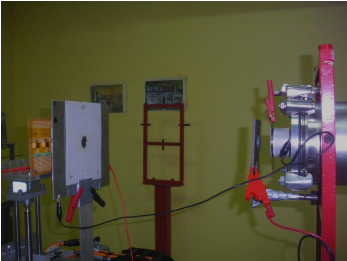
Figura 4.3: Ejemplo de set-up experimental para ensayos de irradiación en la línea de haz externo del ciclotrón / Example of experimental set-up for irradiation testing in cyclotron external beam line
