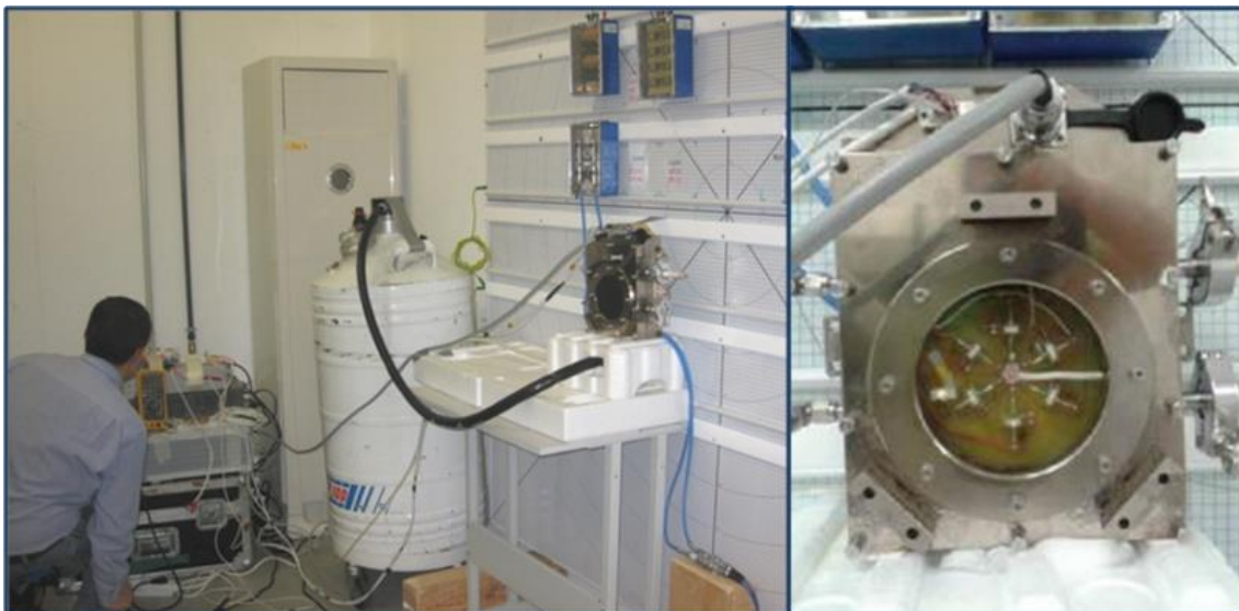
Figura 4.4: Disposición de los equipos necesarios para la campaña de irradiación (izquierda) y cámara diseñada para mantener los dispositivos a baja temperatura durante la irradiación (derecha) / Elements of irradiation campaign (left) and chamber design for irradiation (right)
