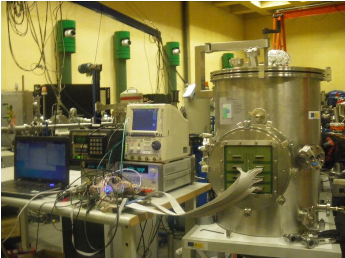
Figura 4.2: Vista general de la Línea de Irradiación e Implantación durante un ensayo de irradiación en dispositivos electrónicos / General view of the irradiation and implantation beam line during electronic devices testing
