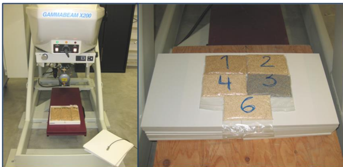
Figura 4.9: Irradiación de semillas de tres variedades de arroz (izquierda) y 5 variedades de quinoa (derecha) para la inducción de mutaciones / Rice (left) and quinoa (right) irradiation
