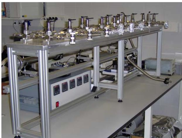
Fig. 2.11.- Línea de grafitización. Laboratorio de radiocarbono
