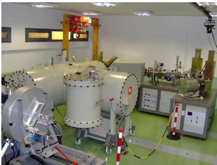
**Fig. 2.9.- Acelerador Tándem de 1MV para AMS del CNA**
