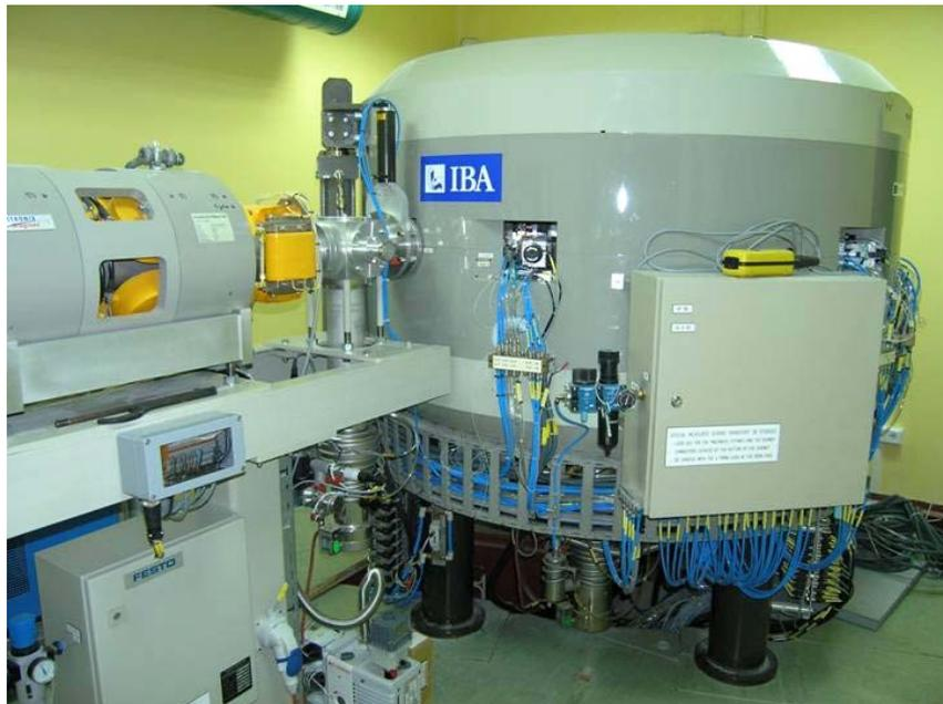
Fig. 2.4.- Acelerador ciclotrón del CNA
