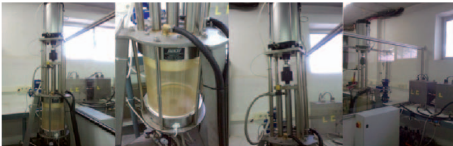
Sistema de modelatge experimental analògic pressuritzable de cambres magmàtiques al SIMGEO. (Autor: J. Martí).
