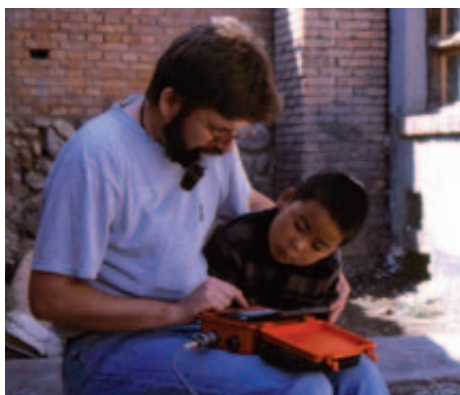
Jordi Díaz mostra a un noi local el funcionament del controlador REFTEK durant un experiment d'adquisició de dades de refracció a la Xina. (Autor: J. Díaz).
