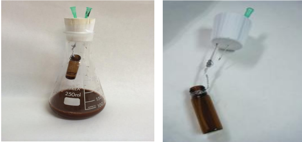
Figura 6. Trampa y modelo final de respirómetro utilizado.
