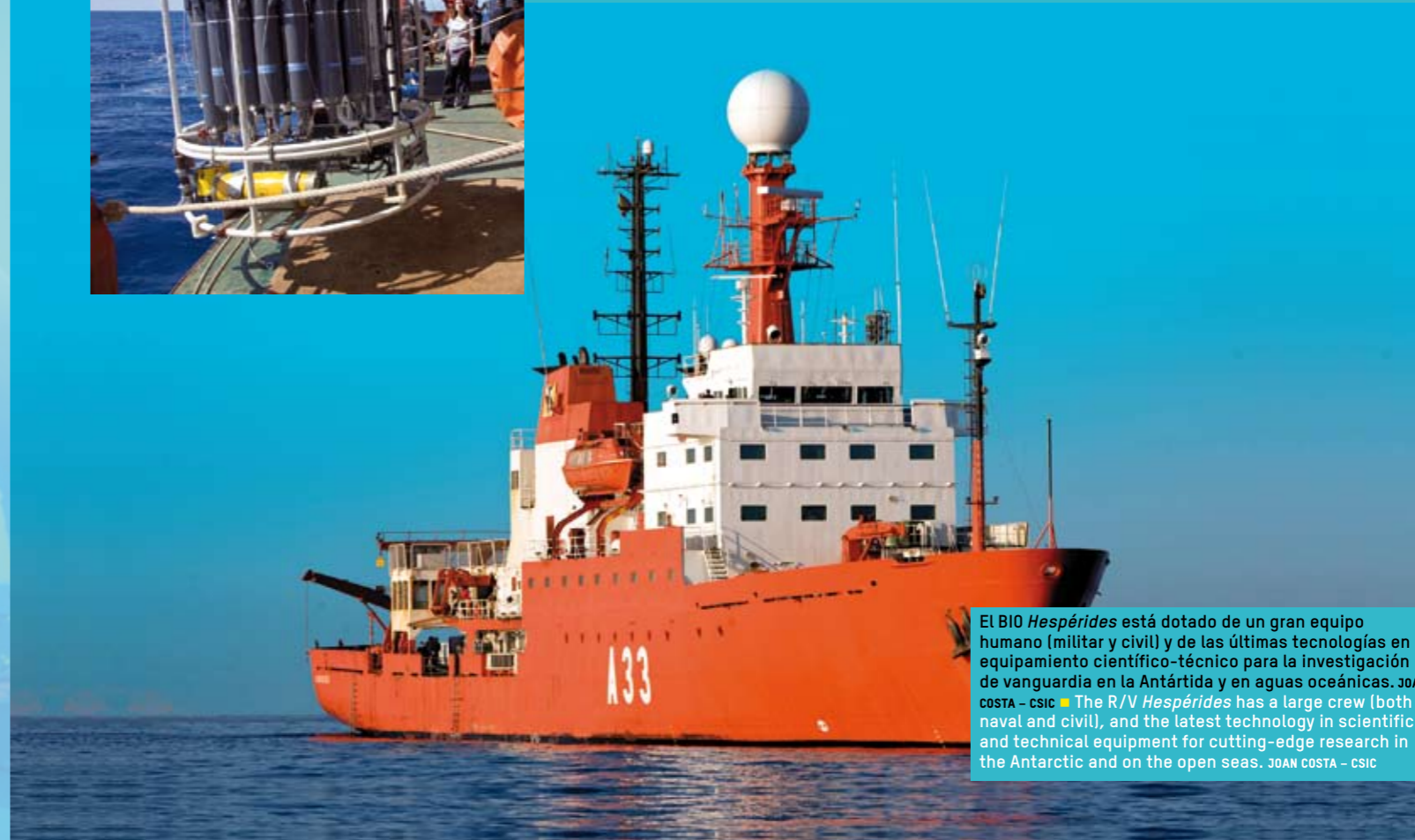
Maniobra de recuperación de la roseta después de que recogiera en una estación numerosas muestras de agua y miles de datos oceanográficos (temperatura, salinidad, etc.) a diferentes profundidades. JOAN COSTA - CSIC • Recovery of the rosette after it has collected many samples of water and thousands of items of oceanographic information (temperature, salinity, etc) in one location at different depths. JOAN COSTA - CSIC
