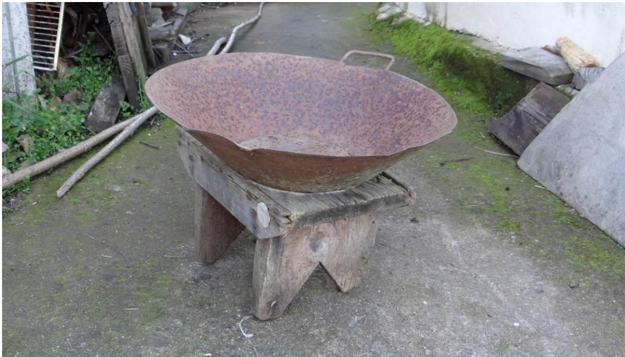
Figura 70: Bateia utilizada na exploração de estanho de aluvião durante o século XX.
