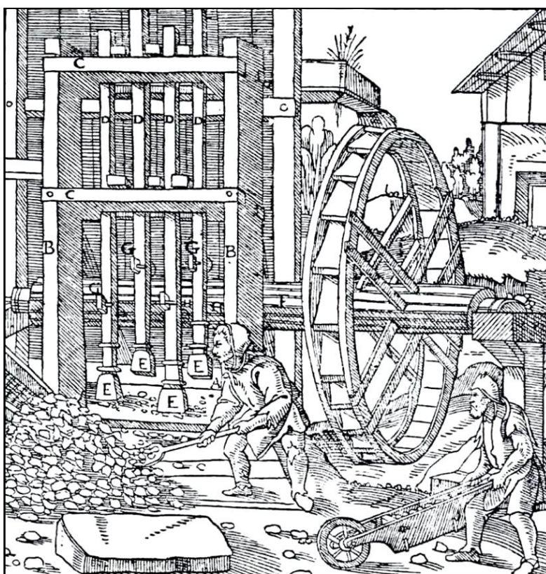
Figura 135: Britagem de minério através de um moinho de água (Agricola, 1556: 284).
