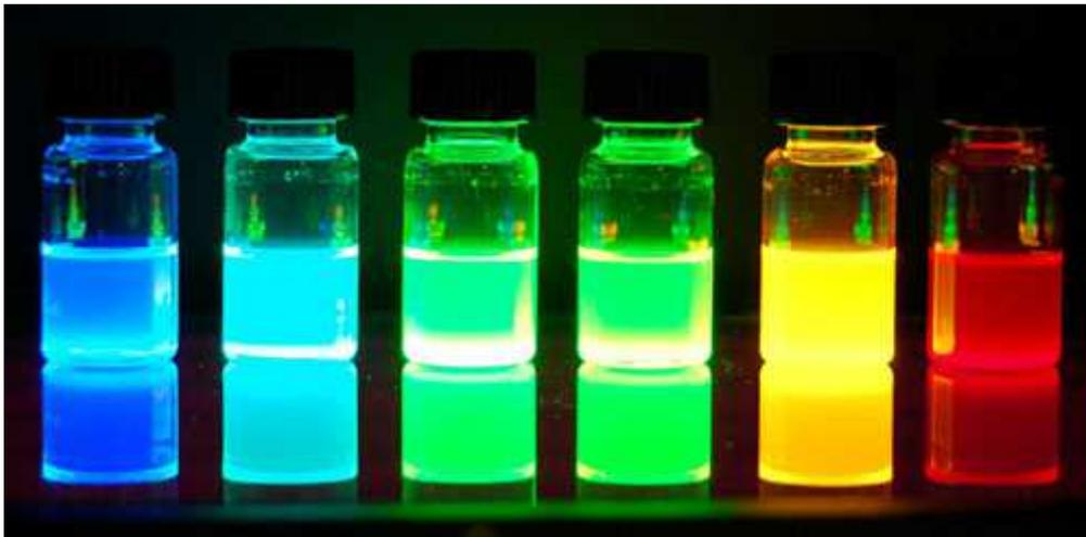
**Figura 2.15: Quantum dots.** Fotoluminiscencia de quantum dots de 6nm de diámetro CdS<sub>x</sub>Se<sub>1-x</sub>/ZnS. El material emite diferente color variando su composición y tamaño. (Sigma-Aldrich)
